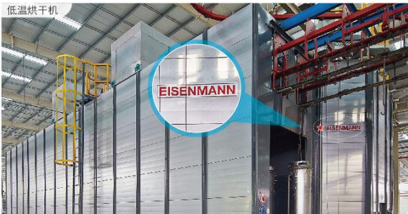
低温烘干机 全自动温度控制,长达一小时的烘干时间,使涂装成果更完美
