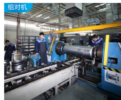
国内首创组对机，双头压进工艺，精度极高
